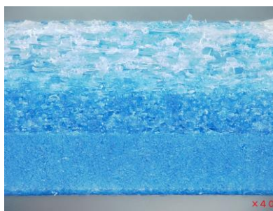
図3. ろ過層断面① (3層構造品) 【型式：MF-6560】
