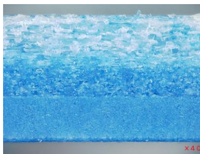
図3. ろ過層断面① (3層構造品) 【型式：MF-6560】
