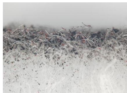
図2. セルの断面図 (拭きカスの保持状態)
