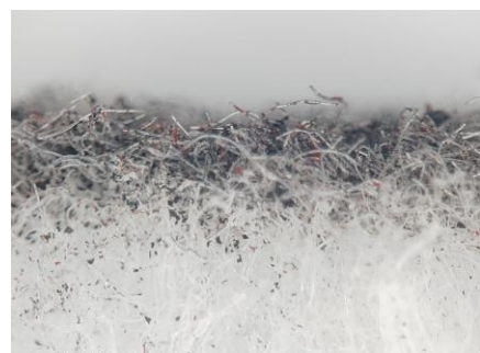
図2. セルの断面図 (拭きカスの保持状態)
